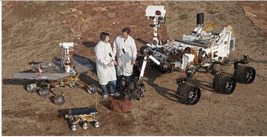
Модели всех успешных марсоходов в сравнении: Соджорнер (самый маленький), Оппортьюнити/«Спирит» (средний), Кьюриосити (самый большой).
